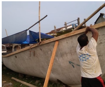
Gambar 4.7 Ilustrasi Pascaproses Pelapisan dengan Mortar
