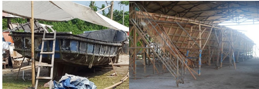
Gambar 4.5 Ilustrasi Cetakan Fiber (kiri) dan Wooden Plug (kanan)
