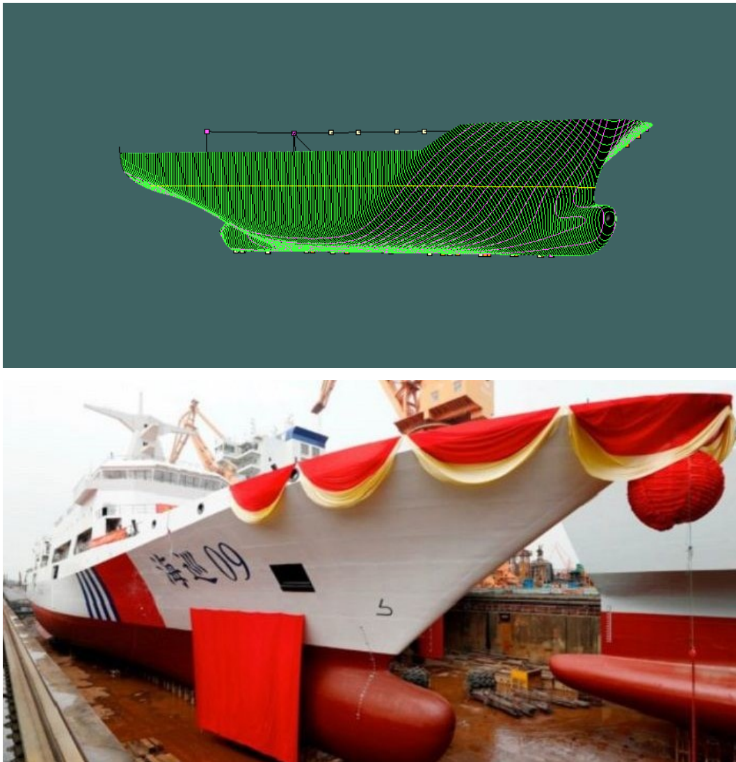
Gambar 4.22 Perbandingan Konsep Desain Lambung Kapal (atas) dengan Lambung Kapal China Coast Guard (bawah)
