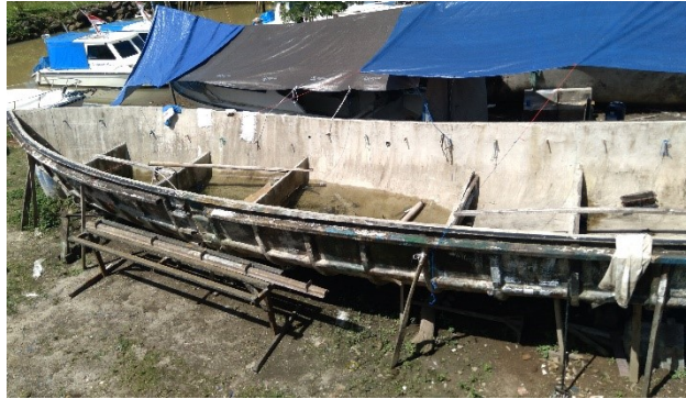
Gambar 4.8 Ilustrasi Penggenangan Air pada Bagian Dalam Kapal
