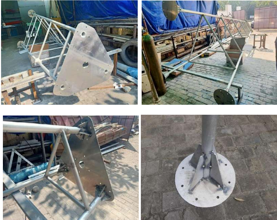
Gambar 6.29 Perkuatan sambungan antar bagian pada tiang ( mast )
