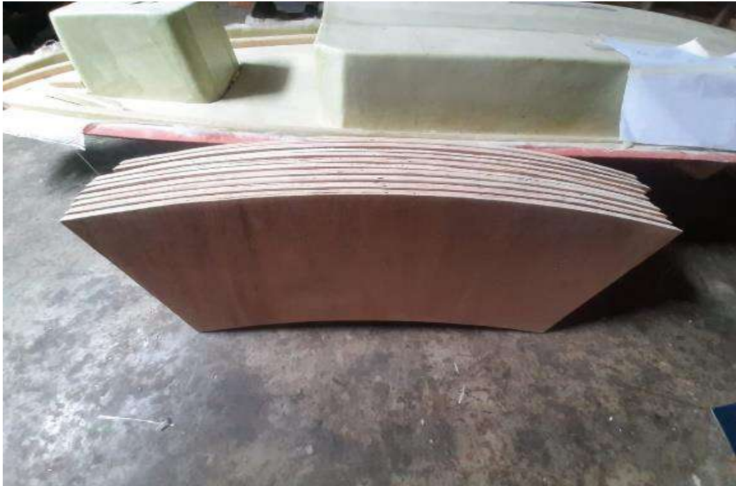
Gambar 6.4 Bekisting bawah moulding
