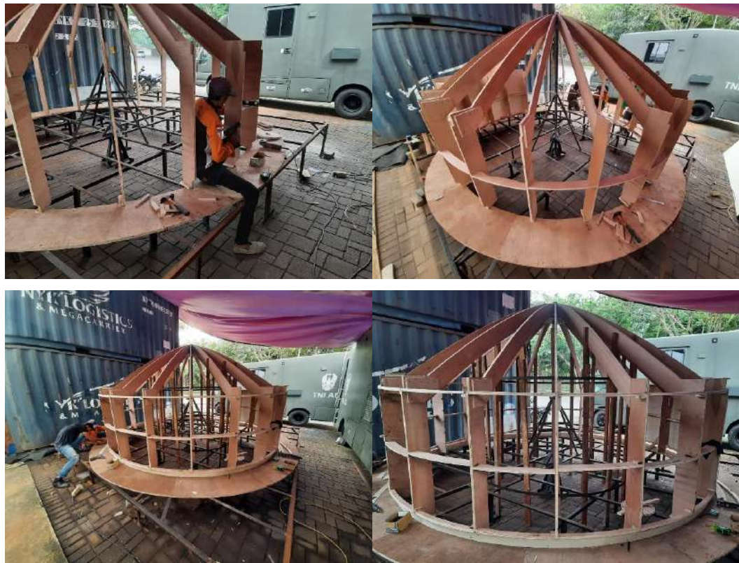
Gambar 6.5 Pembuatan rangka bagian dalam moulding FECABS
