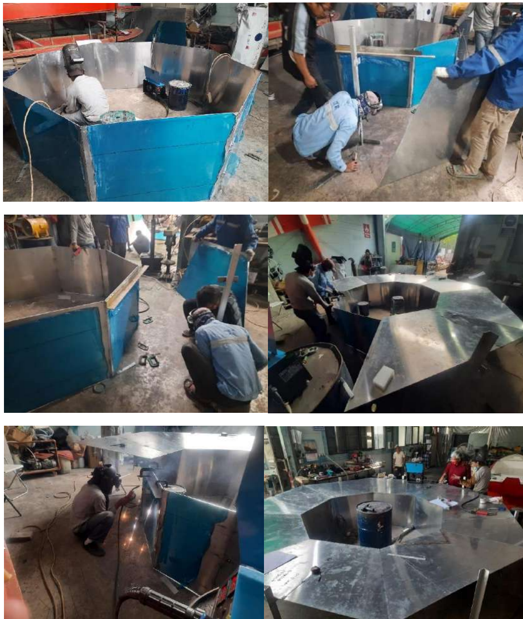
Gambar 6.25 Proses penyambungan bagian suprastruktur FECABS
