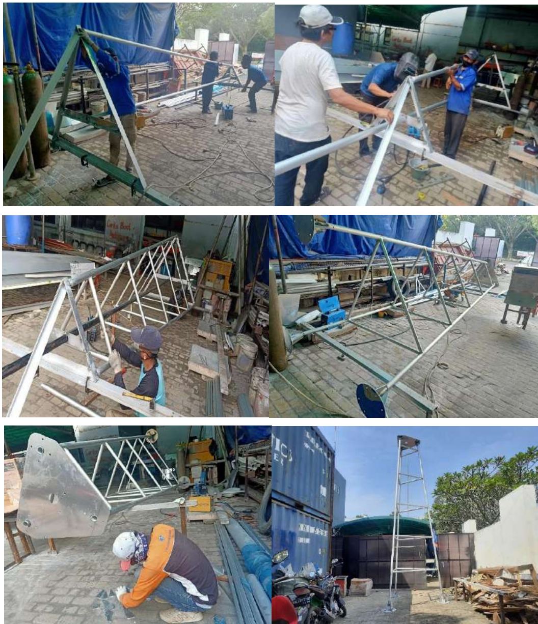
Gambar 6.28 Proses pembuatan Tiang FECABS
