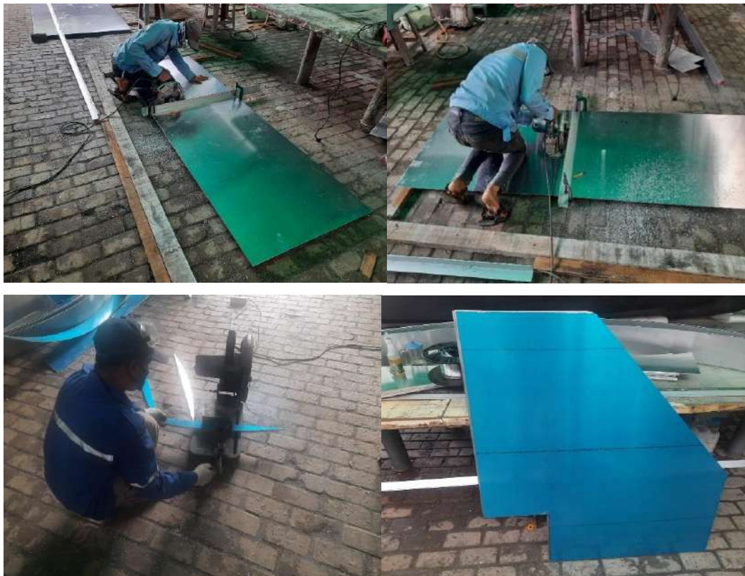
Gambar 6.24 Proses Pemotongan Aluminium untuk FECABS
