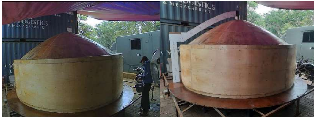
Gambar 6.7 Pelapisan resin pada moulding FECABS
