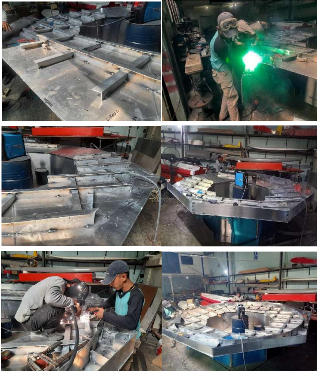
Gambar 6.26 Proses penguatan suprastruktur FECABS
