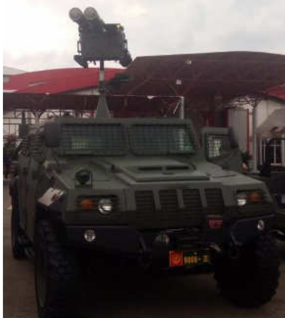
Gambar 4.12 RBS 70 diintegrasikan dengan rantis 4x4 PT Pindad (Sumber : PT Pindad)
