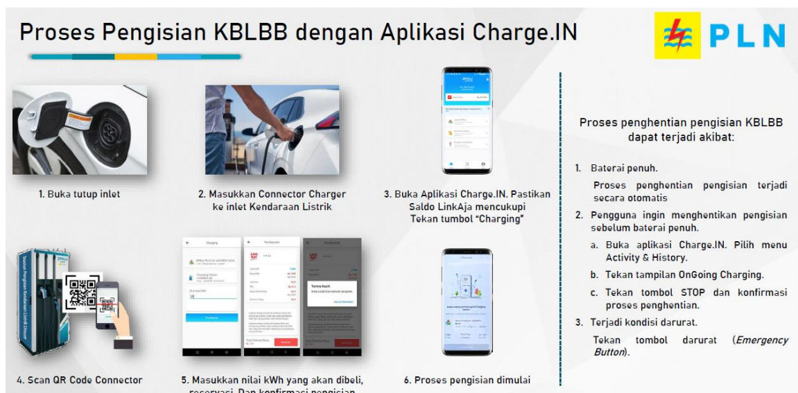
Gambar 4.15 Proses pengisian KBLBB dengan aplikasi charger IN
