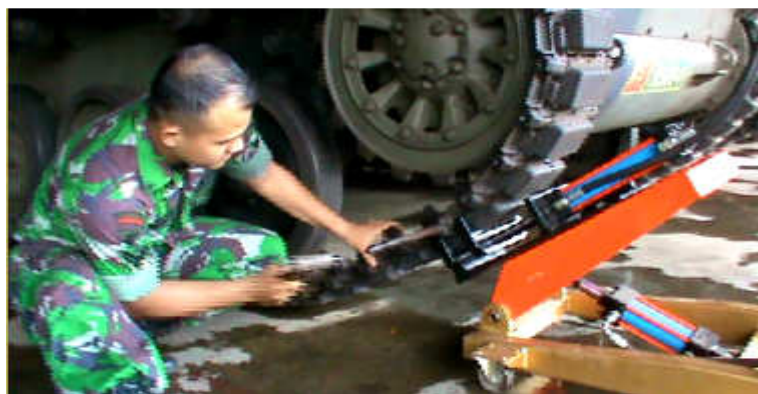
Gambar 2.9 Pemasangan Roda rantai Tank AMX13 metode baru
