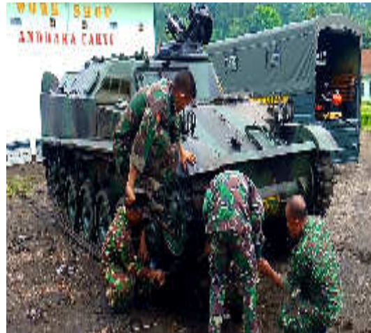
Gambar 4.17 Pemasangan dan Pemukulan Pasak
