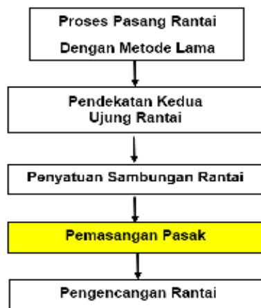
Gambar 4.17 Pemasangan dan Pemukulan Pasak
