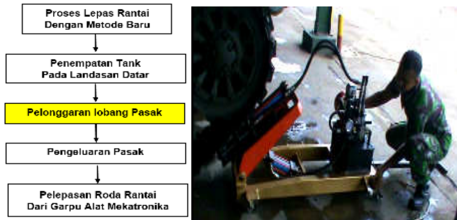
Gambar 4.10 Penempatan Garpu Alat mekatronik Dongpit ke dalam lobang rantai
