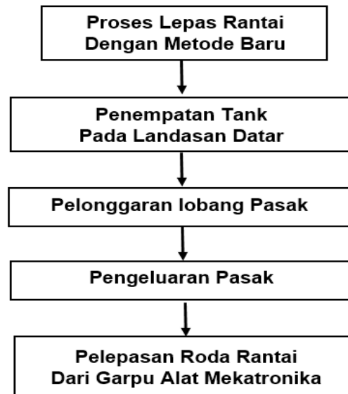
Gambar 4.7 Diagram Alir Pelepasan Rantai AMX 13 Metode Baru
