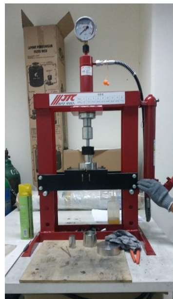
Gambar 3. 3 Alat Kompaksi Manual (Sumber : Dokumentasi penulis, 2021)
