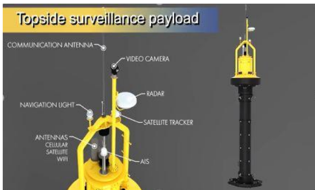
Gambar 2.6 Sensor pada konsep buoy Satuan Operasi TNI AL
