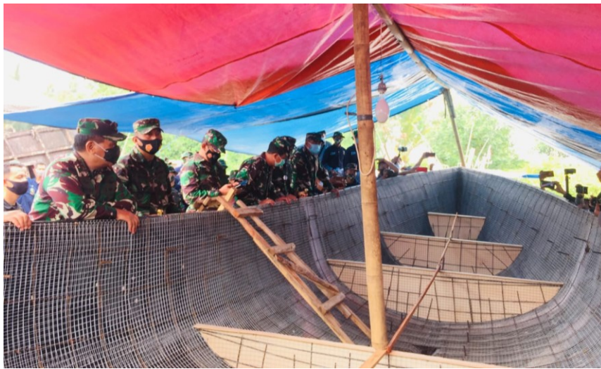
Gambar 1.6 Proses Pembuatan Kapal Ferrocement
