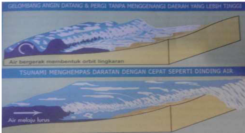
Gambar.2.1 Perbedaan Sifat Pergerakan Air Akibat Gelombang Angin dan Tsunami
