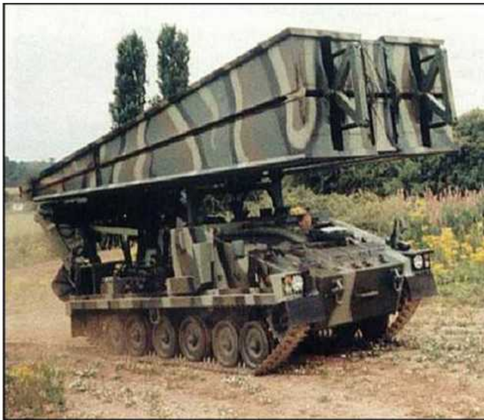
Gambar 4.12 Ranpur AVLB untuk MBT (Tank Jembatan)
