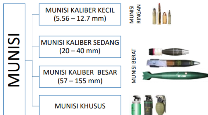
Gambar 2.2 Klasifikasi Munisi Berdasarkan Ukuran Kaliber (Yayat Ruyat, 2021)
