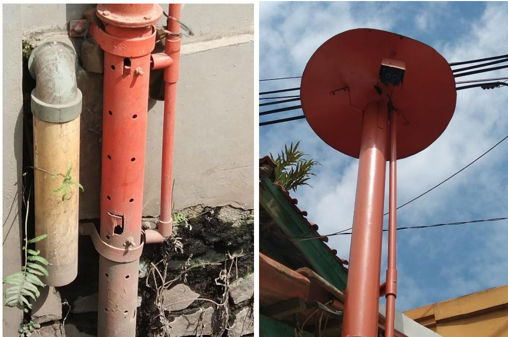
Gambar 8. Alat Sistem Peringatan Dini Banjir di Desa Bojongsoang
