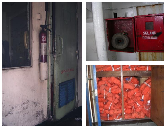
Gambar 4.5 Kondisi Sistem keselamatan Kebakaran Kapal
