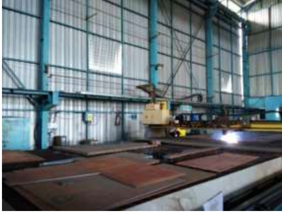
Gambar 11. Pemotongan Plat Baja Menggunakan Mesin CNC (Sumber: Peneliti, 2019)
