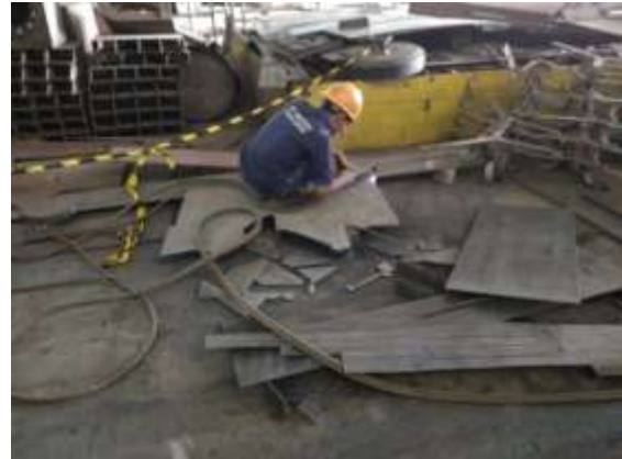
Gambar 10. Pemotongan Plat Baja Secara Manual (Sumber: Peneliti, 2019)
