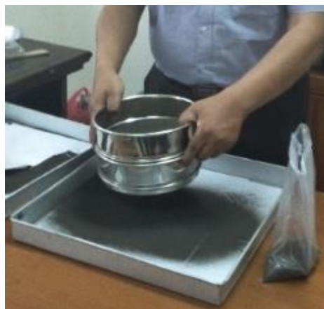
Gambar 4.5 Proses Penyaringan Conto Pasir Besi
