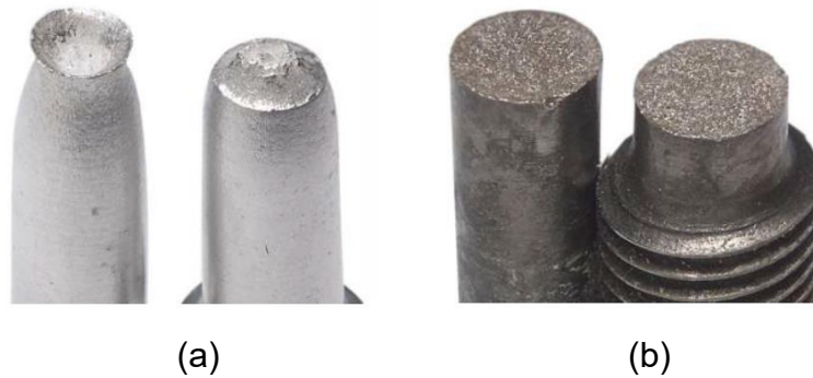
Gambar 2.6 (a) Patah Ulet ( Cup and Cone ) pada Aluminium , dan (b) Patah Getas pada Mild Steel (Callister Jr & Rethwisch, 2018)
