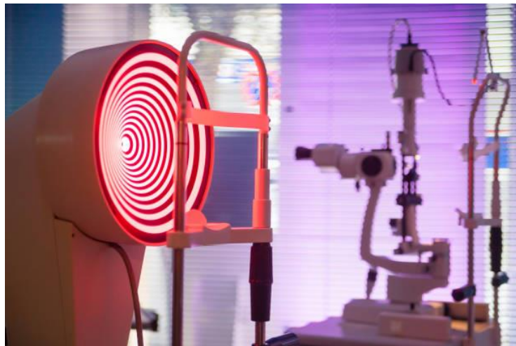
Gambar 2.9 Instrumen topografi kornea yang digunakan untuk membuat model komputer kornea (kubah bening di bagian depan mata).
