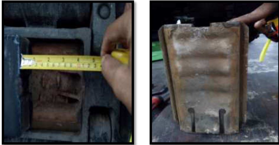
Gambar 4.3 Mengukur pergeseran pad shoe setiap diberikan gaya menggunakan tuas sampai terlepas dari kedudukan track.
