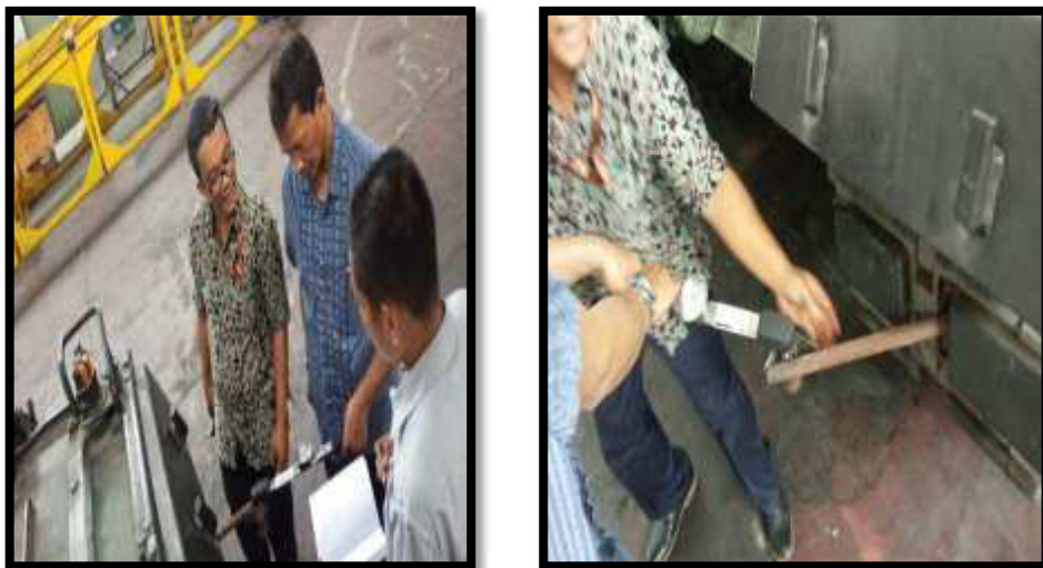
Gambar 4.2 Pelepasan pad shoe dengan memasang alat ukur torsimeter pada tuas
