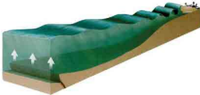
Gambar 2.3 Proses terjadinya tsunami karena penunjaman lempeng
